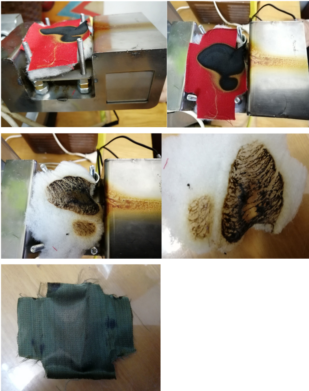
Рисунки 9, 10, 11, 12, 13 - Образцы пакета материала после 30 секунд контакта с нагретой поверхностью до 380^{\circ}\text{C}
